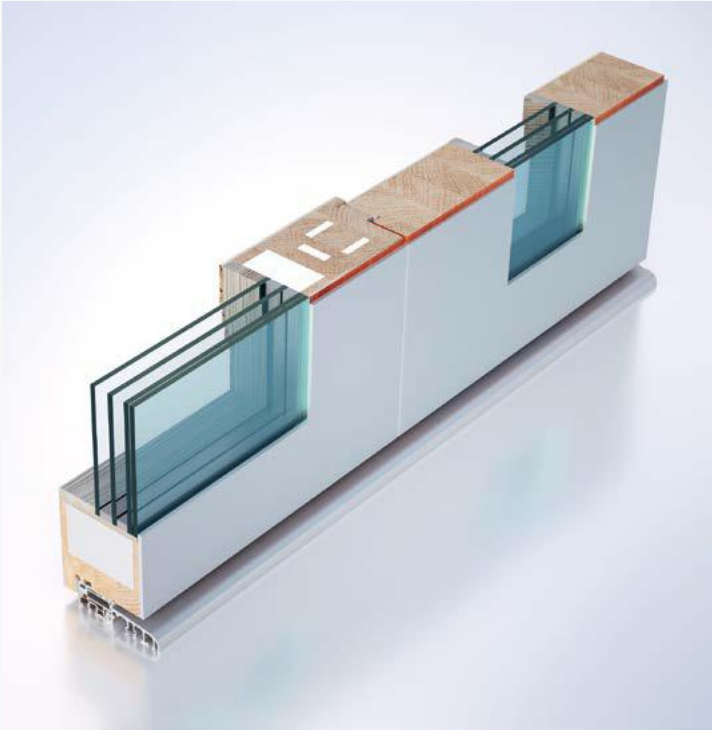
przekrój drzwi aluminiowych z dostawką, gr. 102 mm, drzwi otwierane tylko do środka, dostawka licuje się z ościeżnicą, aluminium na skrzydle, ościeżnicy i dostawce od zewnątrz
